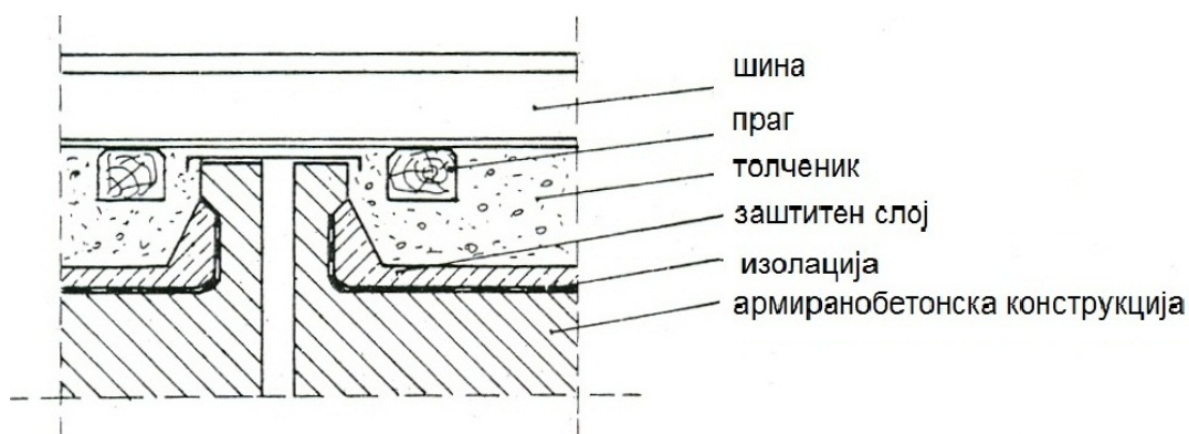
Сл.91. Дилатација кај железнички мост
