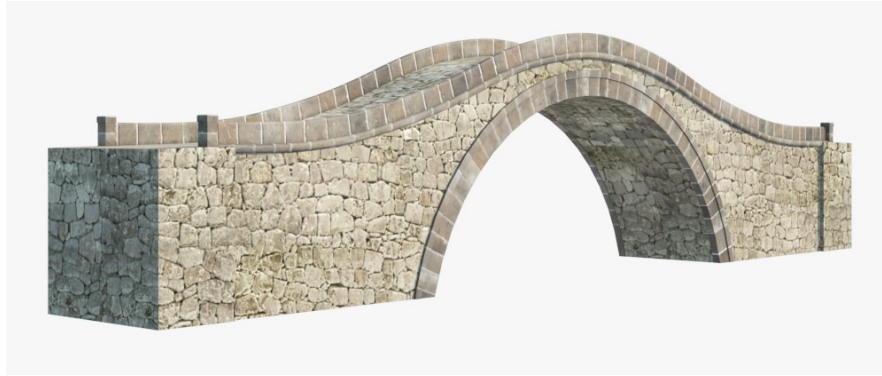
Сл.53. Параболичен пропуст
