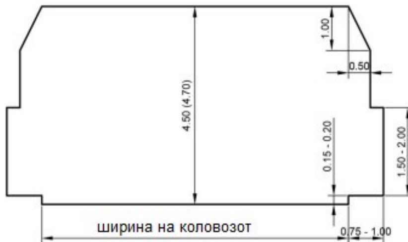
Сл.1. Слободен профил на патен тунел
